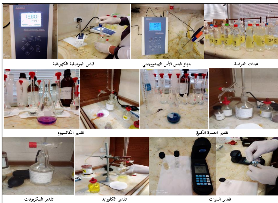
الشكل 3: أجهزة وطرق تحليل عينات المياه الجوفية في منطقة الدراسة
